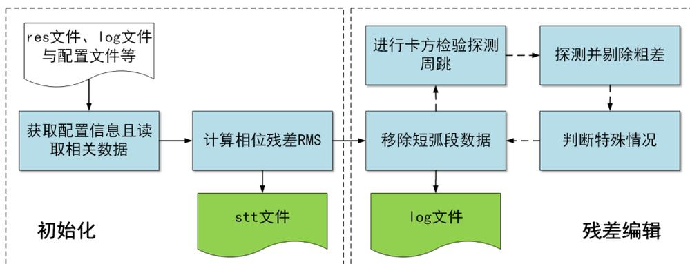
图 4-4 redig 算法流程。黑色虚线指向流程只执行一次
