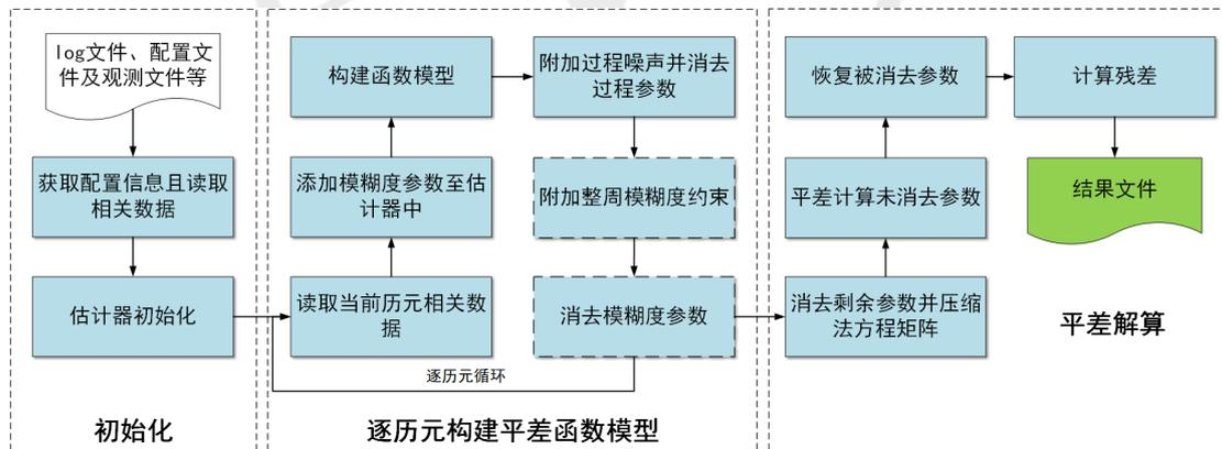
图 4-3 *lsq* 算法流程。只有消去模糊度参数时才执行虚线框部分
