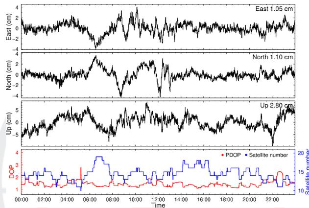
图 5-30 abpo 测站 2024 年 001 天默认解算（K 模式）定位时序图
