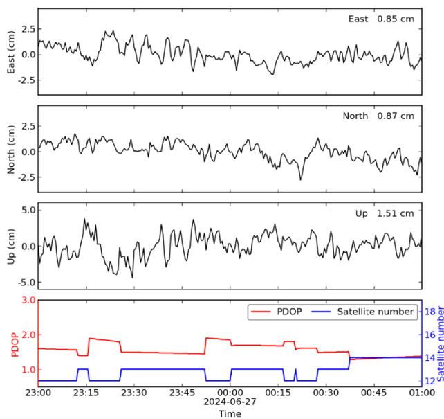
图 5-31 bamf测站 2024 年 178-179 天跨天解算定位时序图（截取日界前后半小时结果）
