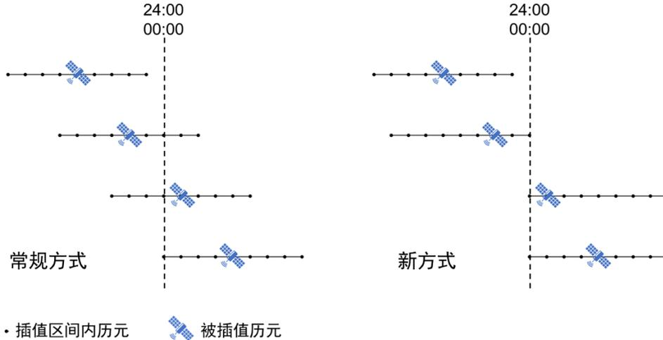
2) 读入 Bias-SINEX 文件中的伪距和相位 DOCB 值，按照选择的信号通道计算各卫星的连续性指标，如果 DOCB 值大于指定阈值（如 0.10 周），则该卫星的快速产品在该信号通道上的观测值不能支持跨日界连续解算，因此需在日界（零点）处将该卫星对应的模糊度参数强行重置（断开）。Bias-SINEX 中的伪距和相位 DOCB 值的格式定义如下：
