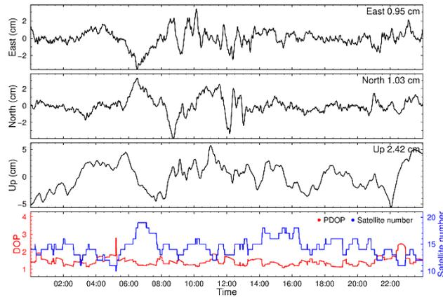
图 5-29 abpo 测站 2024 年 001 天历元间约束（量级为 0.0001 m/sqrt(s)）解算定位时序图
